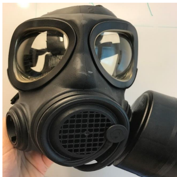
Figur 2 Demontera en av pluggarna och montera filtret där. Vanlig skruvgänga som ibland kan sitta hårt.
