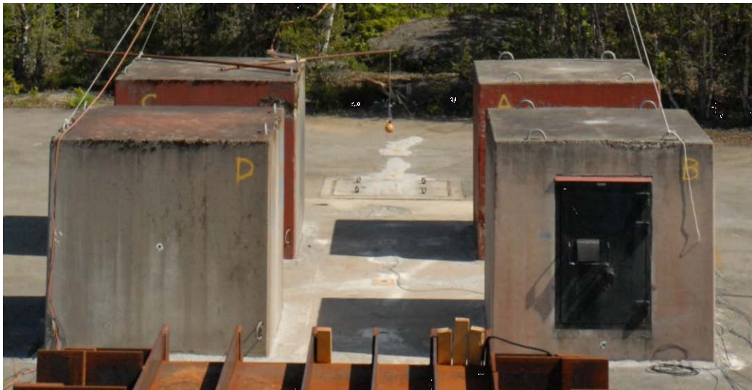
Figur 2.3 Foto på försöksuppställning. Övre fotot visar en laddning på 0,4 kg (orange sfär) placerad i läge #3 på höjden 0,20 m medan undre fotot visar en 1,6 kg laddning placerad i läge #4 på höjden 1,15m.
