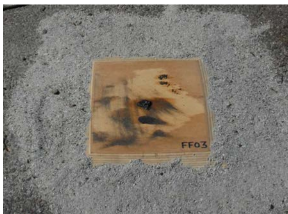
Figur 2.4 Tryckgivare på mark. Givaren fästes i en träskiva som skruvades fast i underlaget (asfalt eller betong) och omgavs med sand för att säkerställa en mjuk övergång från asfalten till skivans överkant.
