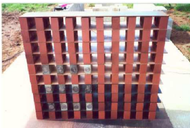
Figur 4.17 Modellbyggnad med porositet 48 % där porositeten definieras som area öppningar / total fasadarea. Från Smith et al. (2003a).
